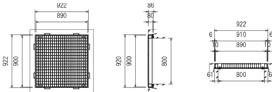
鋼製蓋 (A・B型用) アスカーブ用 (排水性舗装)
