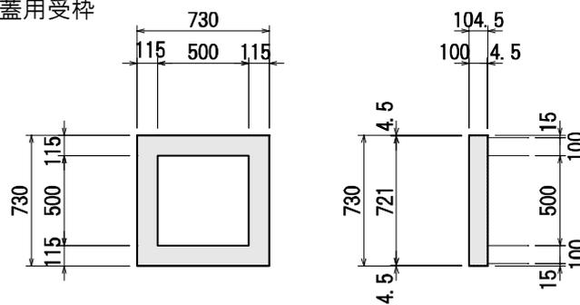
※受枠はコンクリートシーリングを施工する際に用いる。
