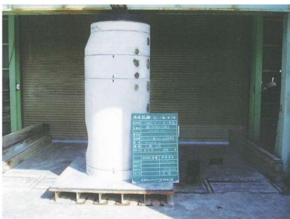
試験は、組立マンホール上部に 150KN の荷重を載荷し部材に異常がないことを確認しました。
